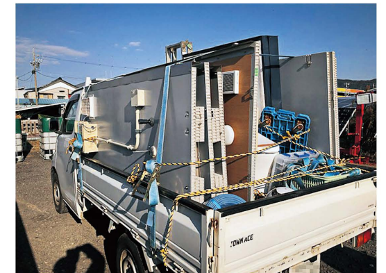
1tトラックに2台のトイレを分解して運搬可能
